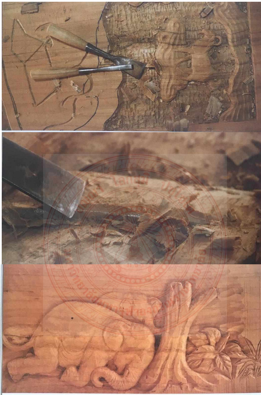
ภาพที่: ๔.๒๗ การสกัด แกะเซาะร่องไม้ ให้เป็นไปตามรูปทรงที่กำหนดไว้
