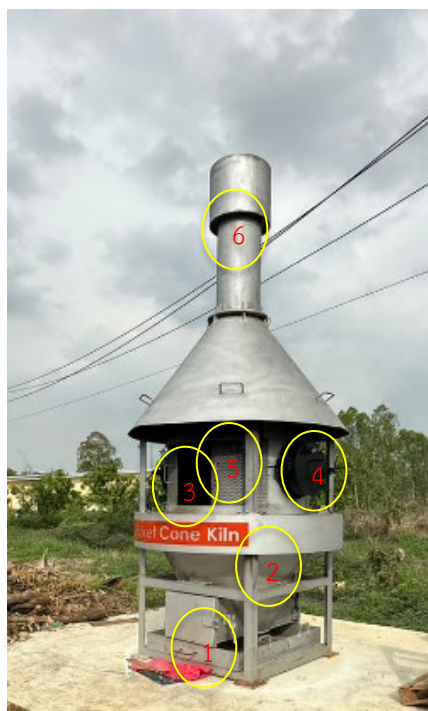
ภาพที่ 4.12 เตาเผาขยะพลังงานชีวมวลต้นแบบและแสดงระบบการทำงานของเตาเผา
