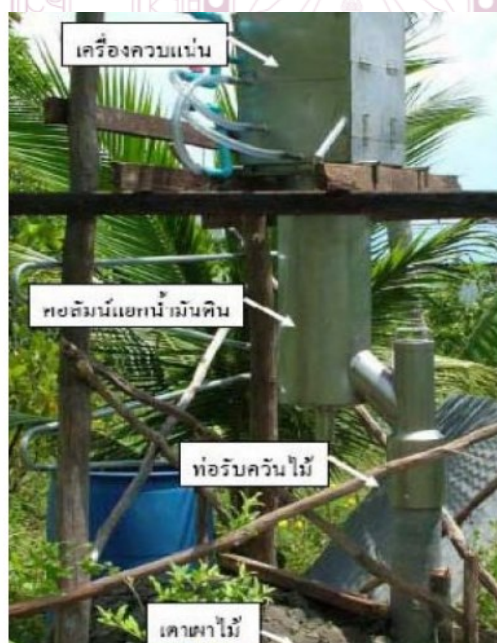
ภาพที่ 2.13 เครื่องแยกน้ำมันดินออกจากน้ำส้มควันไม้
