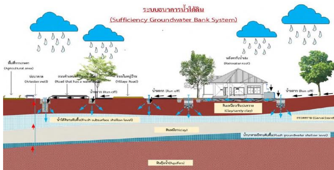
แผนภาพที่ ๒.๕ ระบบธนาคารน้ำใต้ดิน ๔๓
