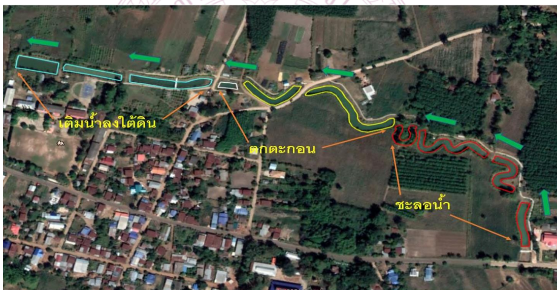
แผนภาพที่ ๒.๖ ระบบธนาคารน้ำใต้ดินระบบเปิดกรณีลำห้วย ๔๔
