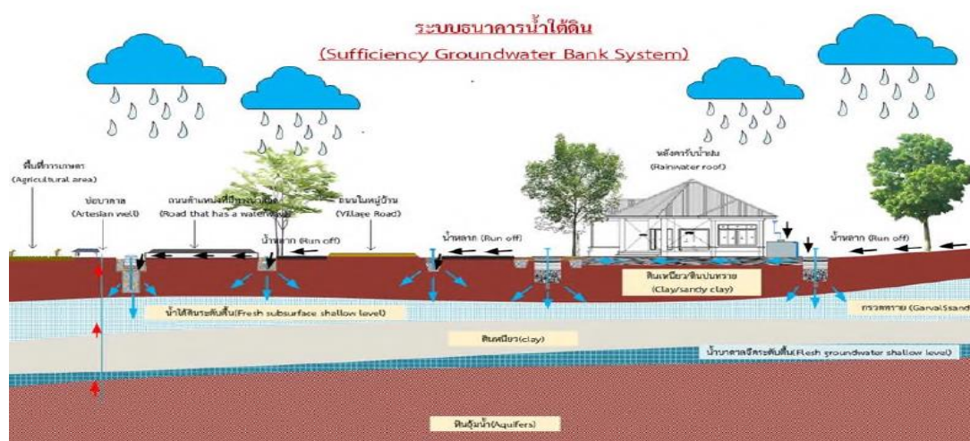
แผนภาพที่ ๒.๕ ระบบธนาคารน้ำใต้ดินแบบพอเพียง (SGB) ๓๘
