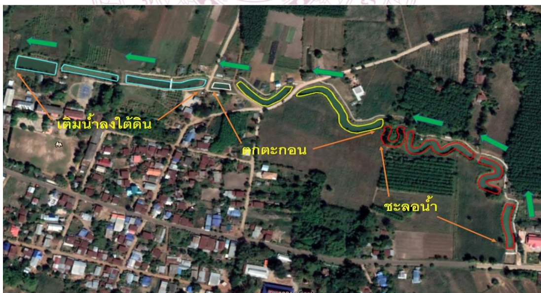
แผนภาพที่ ๒.๔ ระบบธนาคารน้ำใต้ดินระบบเปิดกรณีลำห้วย ๓๒
